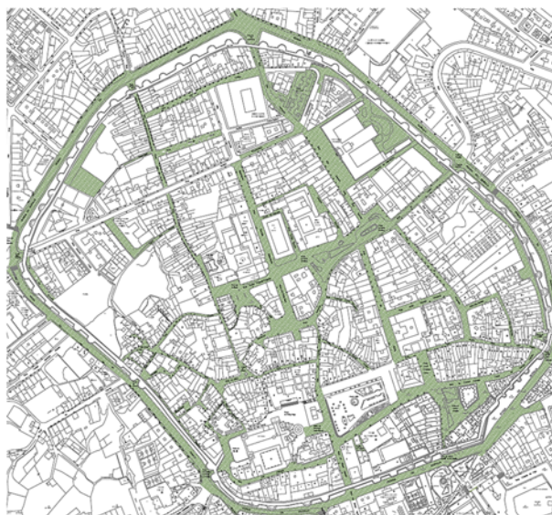
Actuaciones de urbanización en el ERRP (en verde obras ya ejecutadas)
